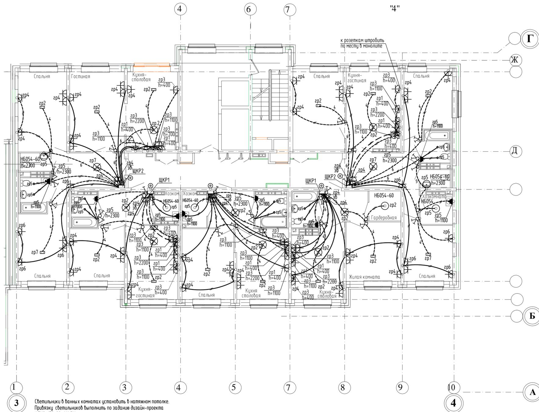
Элитные квартиры предусматривать от щита этажного до квартирного открыто за подвесным потолком. Питание квартир предусмотрено однофазное.
