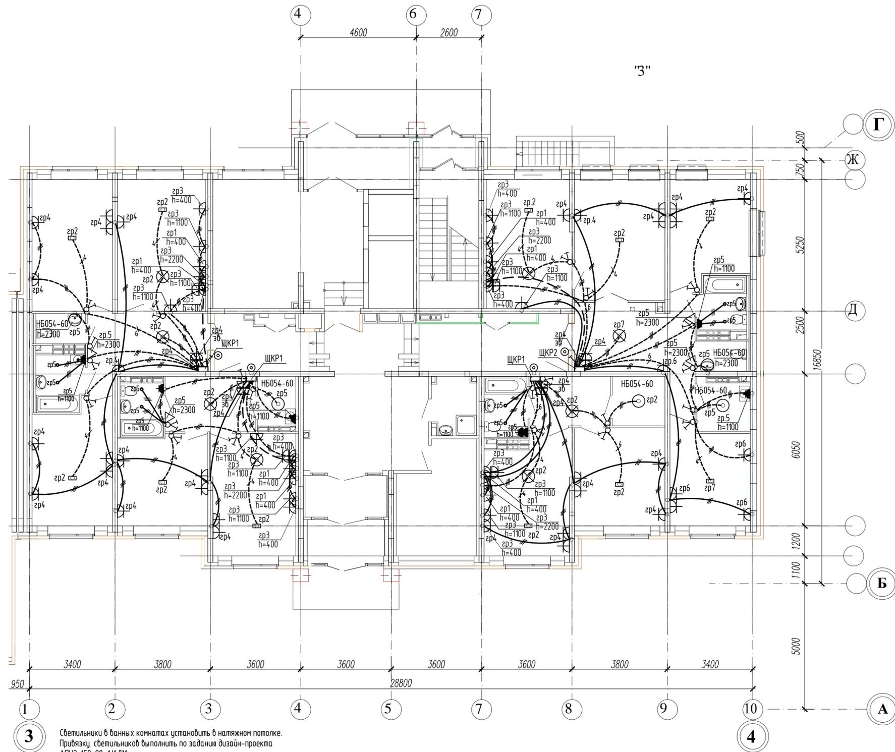
Электроснабжение квартир предусматривать от щита этажного до квартирного открыто за подвесным потолком. Питание квартир предусмотрено однофазное.
